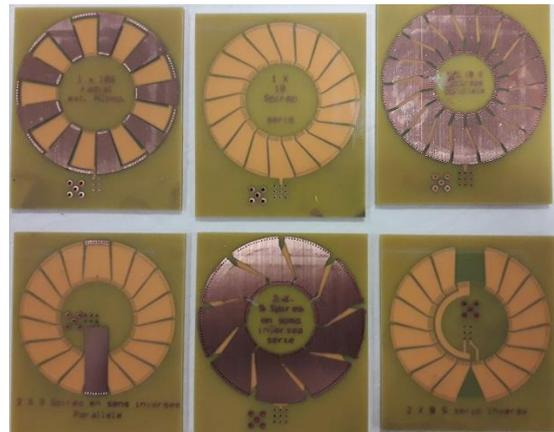
Figure 2 Incorporation dans le circuit imprimé Inducteur
