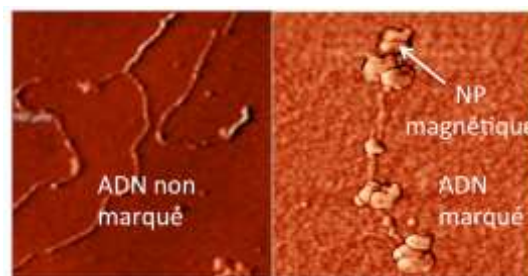
Images AFM confirmant le greffage des nanoparticules sur l'ADN
