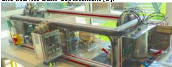
Fig.2. Prototype de convertisseur de récupération d'énergie de freinage
