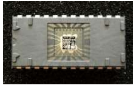
Fig.4: Fonction intégrée de puissance « tout SiC » reportée dans un boîtier
