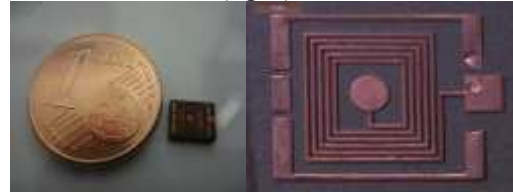
Fig 2. Photos des spires électrodéposées sur du ferrite
