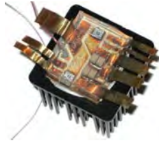
Prototype de module de puissance incluant des JFET en SiC avec capacités de mode commun intégrées.
