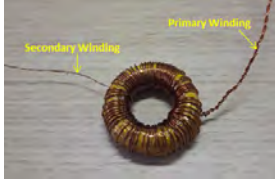
FIGURE 4: Noyau torique bobiné en ferrite.
