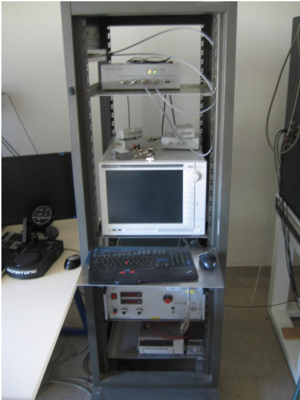
FIGURE 4 – Analyseur de composant de puissance et traceur Agilent B1505A
