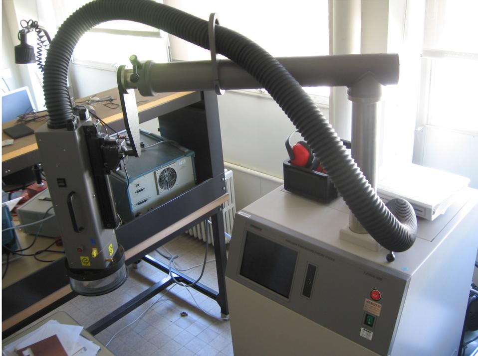
FIGURE 5 – Conditionneur thermique Thermonics T2500E/300
