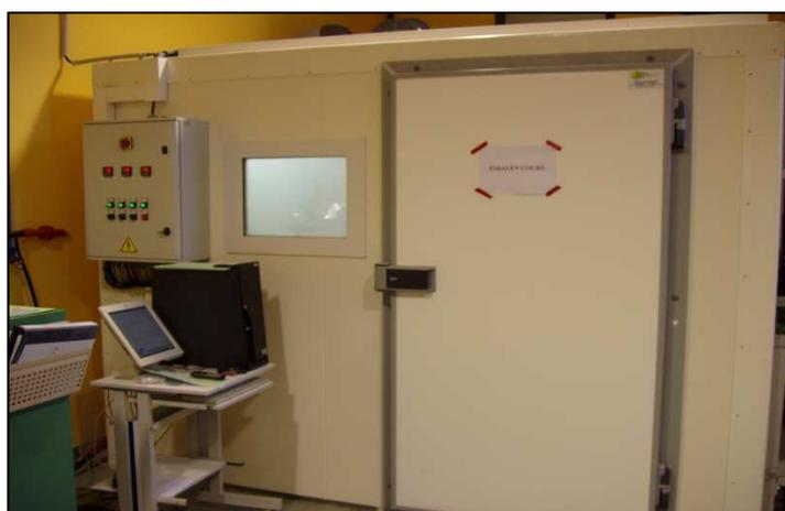
**Figure 3.** Enceinte de brouillard salin.
