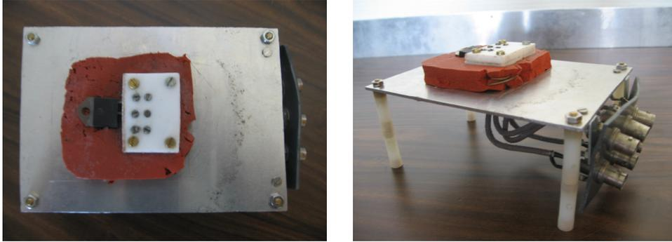
FIGURE 6 – Support mécanique de caractérisation électrique en haute température
