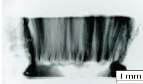
Figure 1.4 : Propagation des dislocations dans les films de diamant déposés par CVD
