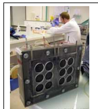
Crédits : Jean-Michel Monier Exemple de biopile alimentée en flux continu par des effluents
