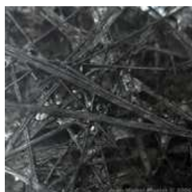
Crédits : Jean-Michel Monier Electrode avant et après colonisation par les bactéries électro-actives présentes dans l'effluent.
