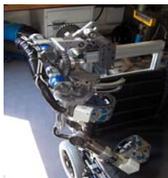
Fig. 2 : Exosquelette de membre supérieur
