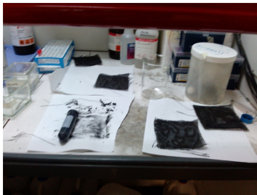
FIGURE 8 – Aspect des cathodes après séchage de la première couche
