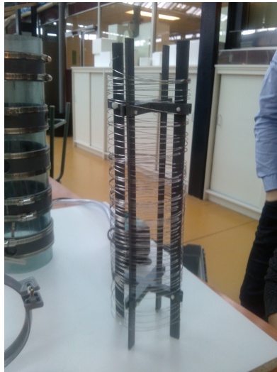
FIGURE 11 – Anode (fil en acier inoxydable) enroulé autour des renforts
