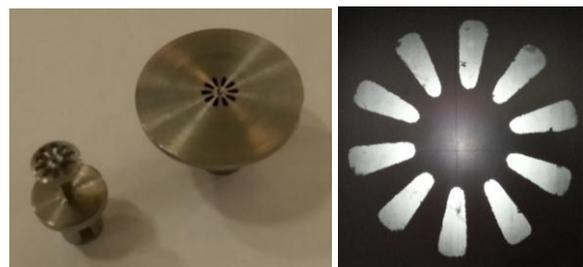
Fig.3. a) Disques fabriqués pour essais de débit et banc de frottement. b) Détail des fentes usinées.
